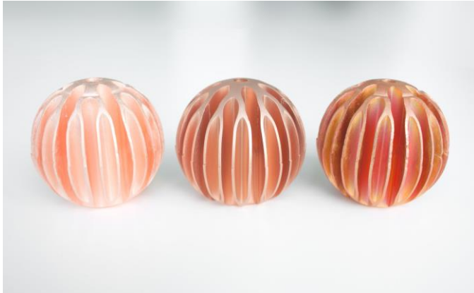
Abbildung 5.8: Oberflächenbehandlung der Sinterteile aus Kupfer von links nach rechts: unbehandelt, sandgestrahlt mit Korngröße 30 \mu\text{m} , CVD-beschichtet mit 300 nm bis 400 nm \text{SiO}_2\text{s}
