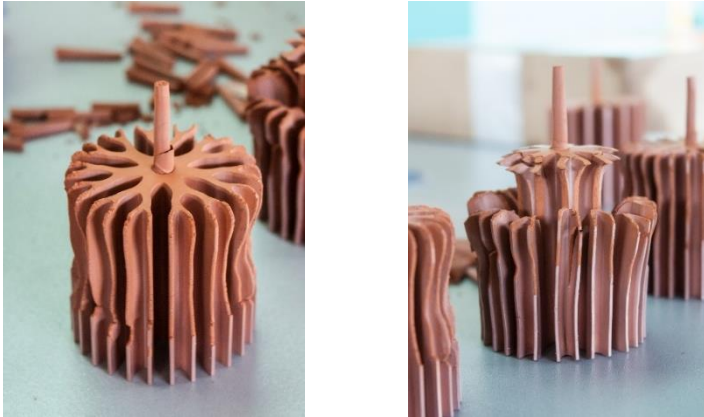
Abbildung 5.5: Fehlerhafte Grünteile – links: unvollständig gefülltes Teil; rechts: beim Entformen zerstörtes Teil
