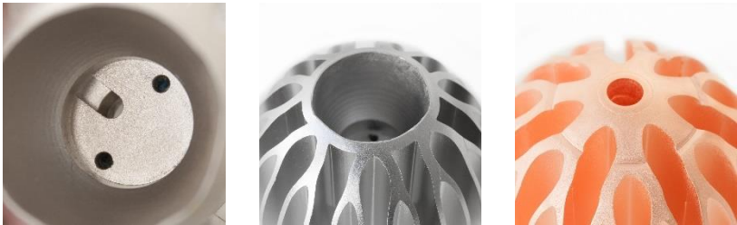
Abbildung 6.2: Details der Fertigteile: LED-Aufnahme mit Kabeldurchführung (links); Deformierter Reflektor (Mitte); Abdruck der ringförmigen Sinterauflage (rechts)
