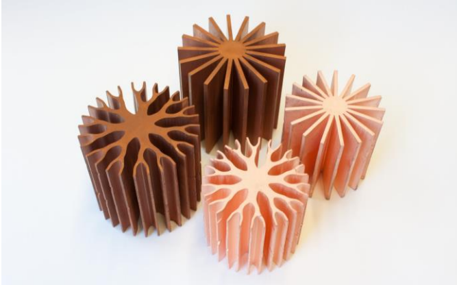
Abbildung 5.6: Zylinderförmige Kühlkörper als Grünteile sowie entbindert und gesinterte Fertigteile
