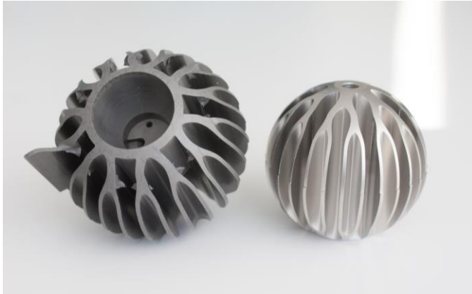
Abbildung 5.7: Musterteile aus Edelstahl - links: Grünteil aus Werkzeug mit ausgebrochenem Auswerfer an einem Teillast; rechts: Gesintertes Fertigteil
