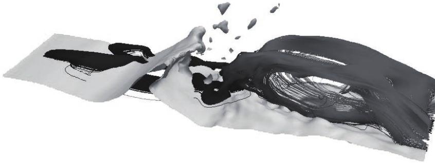
Abbildung 2.5: (Luft-) Wirbel stromabwärts einer Welle
