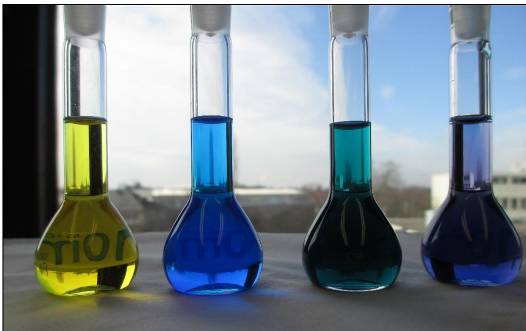
Abbildung 1-1: Die vier in der VRFB verwendeten Oxidationszustände von Vanadium gelöst in 2 M H_2SO_4 . Von links nach rechts: V^{2+} , V^{3+} , V^{4+} , V^{5+} .
