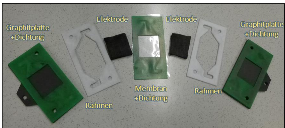
Abbildung 3-2: Aufbau der Einzelzelle. Zu sehen sind die Graphitplatten, Dichtungen, Rahmen für die Elektroden, die Membran und die beiden Elektroden.
