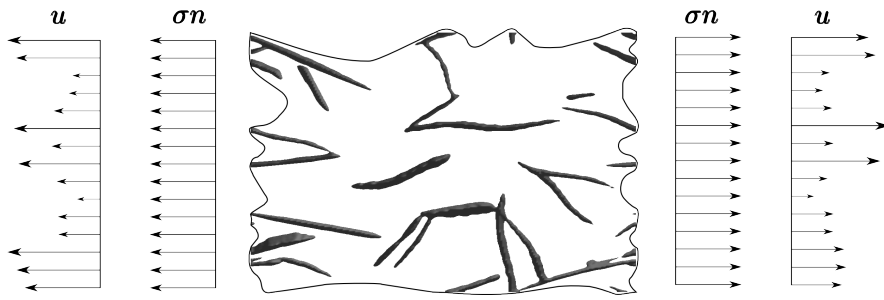
Abbildung 14.3: Darstellung der SU-Randbedingung für das Ausgangsmaterial aus Abbildung 14.1 mit den gleichmäßigen Spannungswerten auf den Rändern \partial V und den für ein heterogenes Material ungleichmäßigen Verschiebungswerten im Randbereich.
