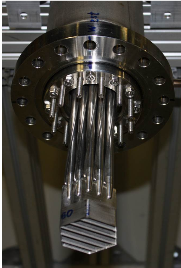
Bild 5.11: Einbau des Brennstabes in die Teststrecke. Zu erkennen sind das Ende des Brennelements mit der Brennstabfixierung.
