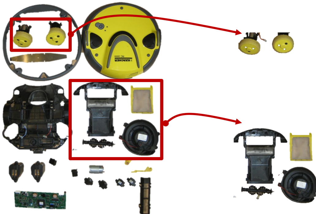
Bild 21: Prinzip und Umsetzung der Sichtenbildung: Gesamtsystem und spezifische Sicht „mechatronische Komponenten“ durch Ausleitung der „Reinigungsbaugruppe“ und „Antriebsstrang“
