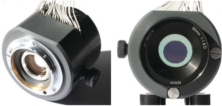
Abbildung 4: Umgebautes Objektiv mit F-Bajonett (links) und Blick entlang optischer Achse mit angesteuertem LC-Display (rechts).
