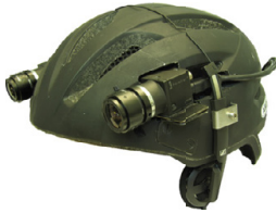
Abbildung 5: Links: Kameras, Kopfhörer und inertielle Messeinheit (nicht sichtbar) sind prototypisch in einen Helm integriert. Rechts: Proband mit dem System im Testparcours.
