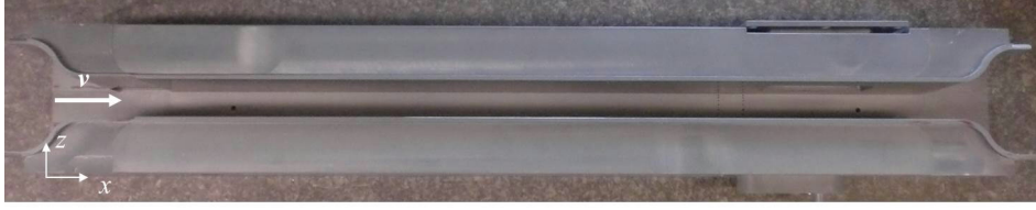
Abbildung 17: Geometrie des schmalen Kanals ( d = 1/3 ) in Draufsicht
