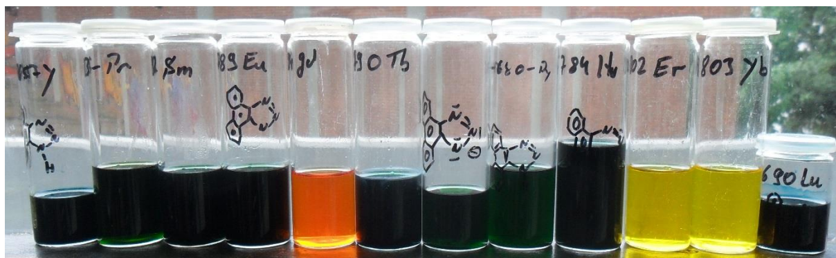
Abbildung 50: Schnappdeckelgläser mit Reaktionen von Lanthanoid(III)nitrat mit Phenanthrendion vor der kristallographischen Untersuchung. Von links nach rechts: Y, Pr, Sm, Eu, Gd, Tb, Dy, Dy, Ho, Er, Yb und Lu.
