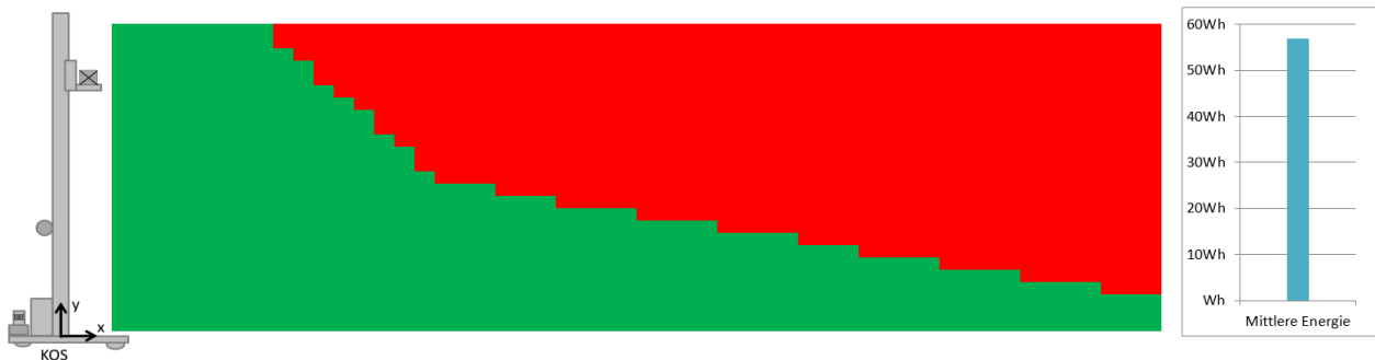
Abbildung 6.10: Darstellung der mittleren Energie der Lagerfront und der Iso-Energetischen für RBG Nr. 2
