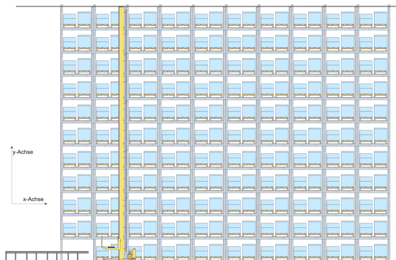
Abbildung 4.3: Systemgrenze und Koordinatendefinition - Frontalansicht der Lagerfront
