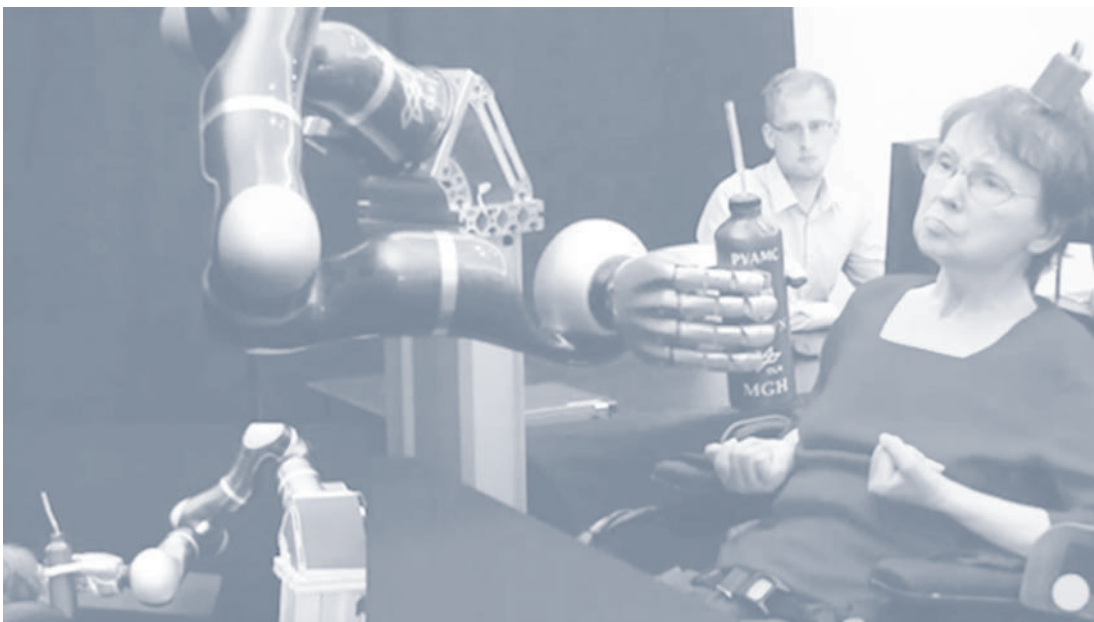
Abb. III.5 Steuerung eines Roboterarms mittels implantierter Elektrode
