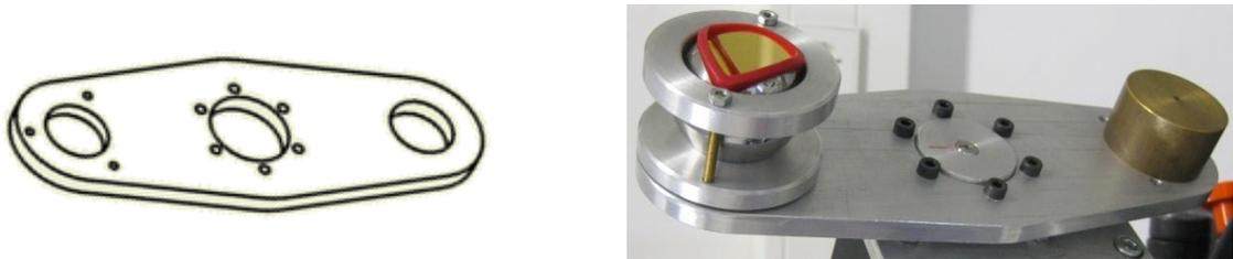
Abb. 31: Zeichnung und Realisierung des Dreharms
