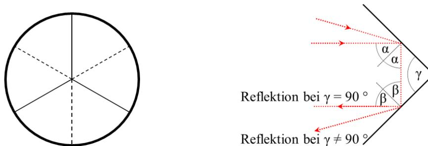
Abb. 27: links: schematische Segmentierung der Spiegelebenen eines SMR; rechts: Schema Auswirkung des DAE bei zwei Spiegelebenen
