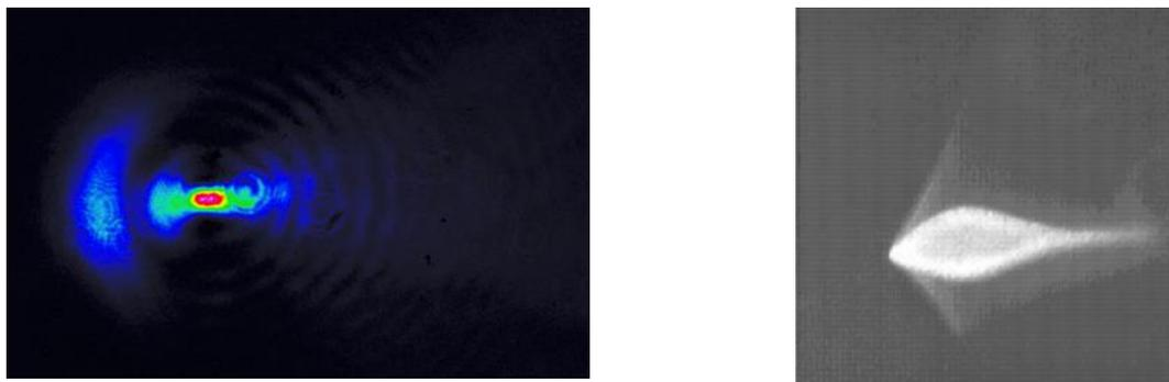
Abb. 71: links: Beobachtete Intensitätsverteilung des vom R160A reflektierten Signals, sphärische Aberration und Koma; rechts: Reflektiertes Signal einer Strahlquelle mit  $r = 55 \text{ mm}$ , [Bernhart 2011]
