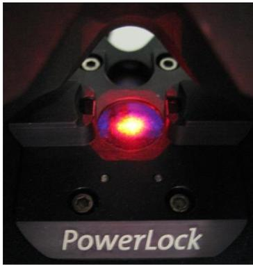
Abb. 56: Vom R160A reflektiertes Signal auf der Cover Plate (ohne Verschiebung)
