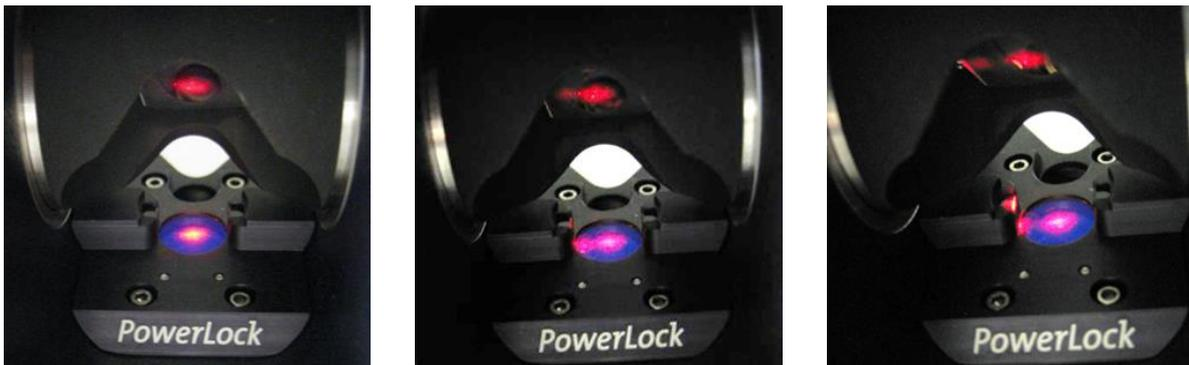
Abb. 55: Position des von einem BRR reflektierten Signals auf der Cover Plate des Lasertrackers AT901 bei zunehmender Verschiebung des Reflektors in horizontaler Richtung quer zum Laserstrahl
