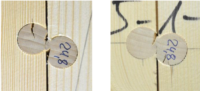
Bild 4-12 Kombination aus Rollschub- und Querzugversagen
