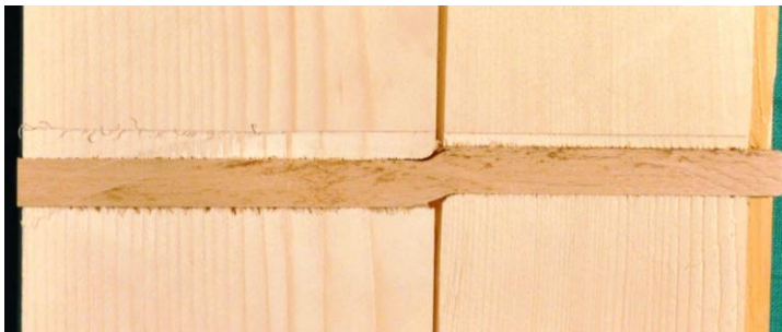
Bild 4-10 Geöffneter Prüfkörper mit bleibender Biegeverformung des Buchedübels
