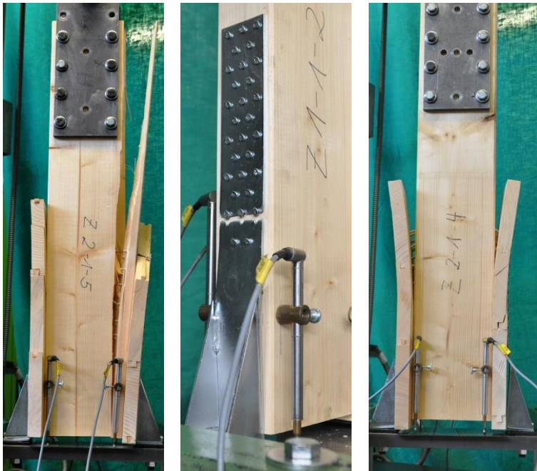
Bild 6-12 Querkzugversagen des Rahmenholzes (links), Zugversagen des Ankers (Mitte) und Schüsseln der Beplankung (rechts)
