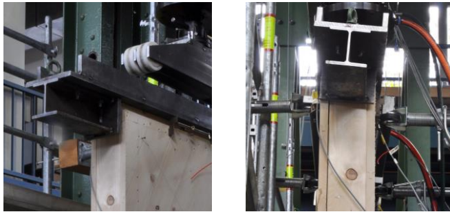
Bild 7-12 Verstärkte Lasteinleitung links und Schiefstellung des Lasteinleiters rechts
