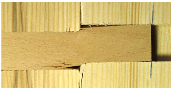
Bild 5-7 Biegezugrisse und Druckfalten und Verdrehung der Leiste für Prüfkörper mit 60 mm Einbindetiefe
