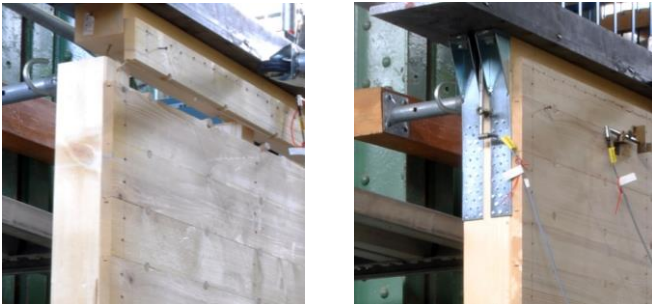
Bild 7-9 WDH-50-1 Versuchsdurchführung ohne zusätzliche Zuganker links und Zuganker zwischen Lastverteiler und Ständer rechts
