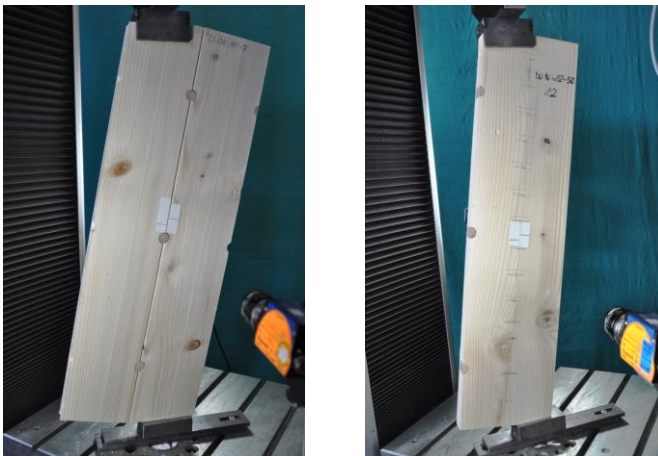
Bild 5-6 Prüfstand für Buchedübelverbindungen (links) und Wellennagelverbindungen (rechts)
