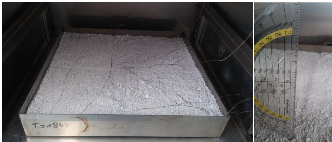
Abb. 4.14: Exemplarische Darstellung des Versuchsaufbaus mit den angeordneten Thermoelementen
