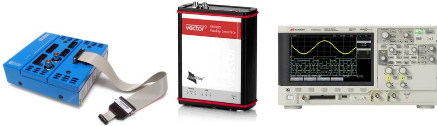
Abbildung 38: Die zur Evaluation verwendete Hardware (v. l. n. r.): IC5000, VN7600, DSOX2012A
