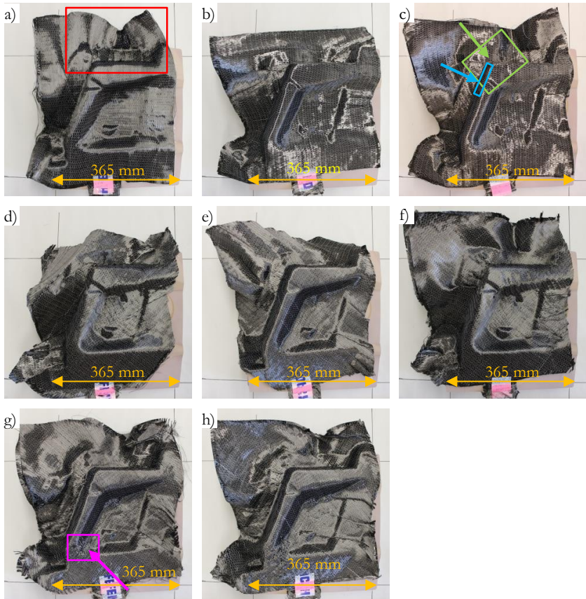
Abbildung B-42: Ergebnisse Lampentopfumformversuche der jeweiligen Lagenaufbauten (Ansicht von oben): a) [0/0/0/0] ; b) [90/90/90/90] ; c) [0/90/0/90] ; d) [-45/-45/-45/-45] ; e) [+45/+45/+45/+45] ; f) [-45/+45/-45/+45] ; g) [0/90/-45/+45] ; h) g) [0/-45/90/+45] .
