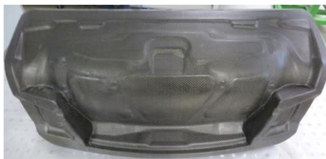
Abbildung A-1: Faserverbundbauteil hergestellt im RTM-Prozess [Hen15].
