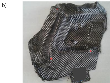
Abbildung A-3: a) Schematische Darstellung der RTM-Prozesskette [Tho15]; b) Gewebe-Preform des Lampentopfdemonstrators, hergestellt im sequentiellen Drapierverfahren [Hen15]; c) Infiltriertes RTM-Bauteil des Lampentopfdemonstrators [Hen15].
