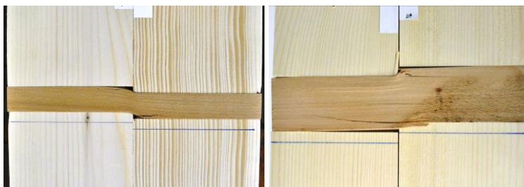
Bild 4-11 Biegezugrisse und Druckfalten im Prüfkörper für Reihe 4-1 (links) und Reihe 4-2 (rechts) und Schiefstellung der Leiste (rechts)
