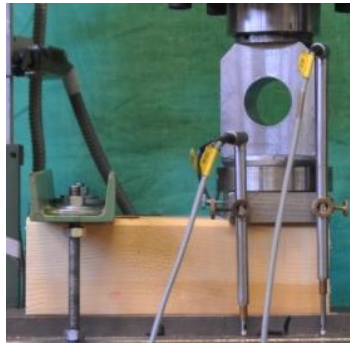
Bild 6-17 Versuchszustand der Querdruckversuche für Reihe R
