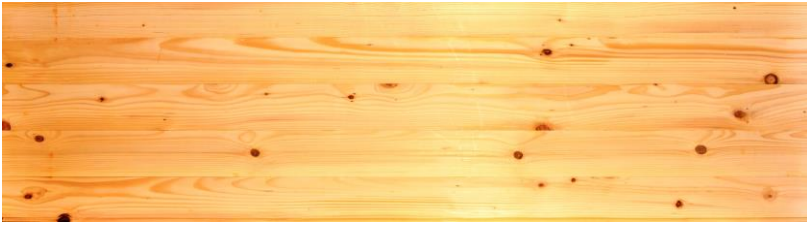
Plattenquerschnitt aus fünf parallel angeordneten Brettern
