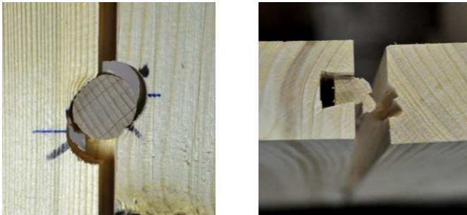
Bild 4-8 Lochleibungsverformung im Fichtenholz sowie Eindrückungen im Dübel (links) und Abreißen der Feder (rechts)
