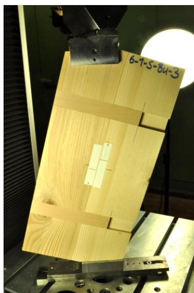
Bild 5-6 Prüfstand für Leistenverbindungen mit 120 mm Einbindetiefe (links) und 60 mm Einbindetiefe (rechts)
