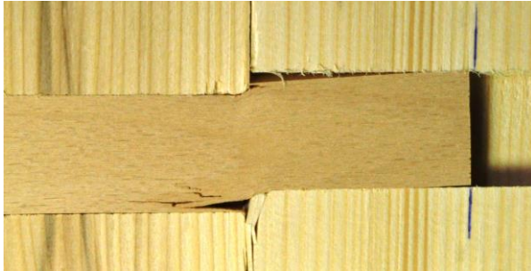
Bild 5-8 Biegezugrisse und Druckfalten und Verdrehung der Leiste für Prüfkörper mit 60 mm Einbindetiefe
