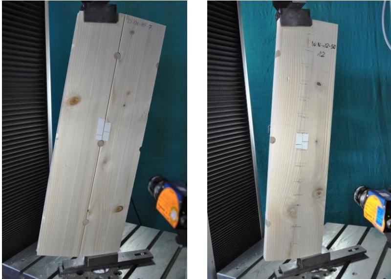
Bild 5-7 Prüfstand für Buchedübelverbindungen (links) und Wellennagelverbindungen (rechts)
