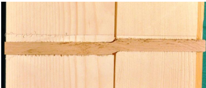
Bild 4-10 Geöffneter Prüfkörper mit bleibender Biegeverformung des Buchedübels
