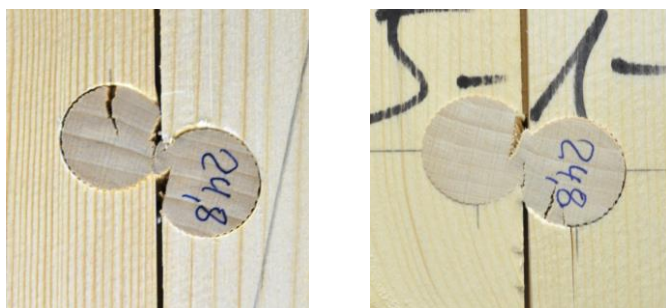
Bild 4-12 Kombination aus Rollschub- und Querzugversagen
