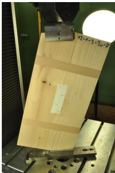
Bild 5-6 Prüfstand für Leistenverbindungen mit 120 mm Einbindetiefe (links) und 60 mm Einbindetiefe (rechts)
