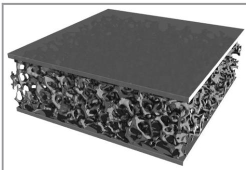
Abbildung 10. Gerendertes 3D CT Bild eines vereinzelt Probe Nr. 1 in Grauwertdarstellung.
