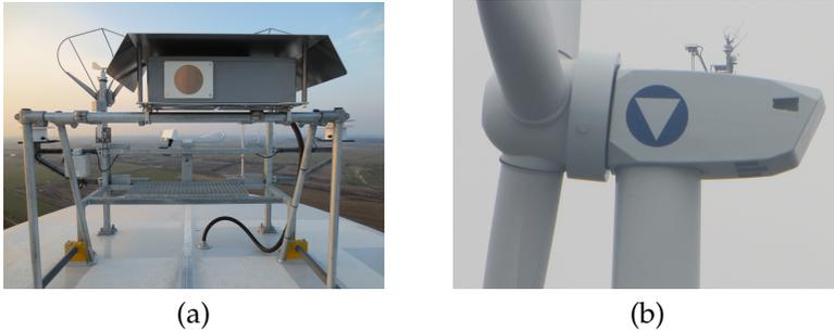
Abb. 8.1.: LAWAL Sensor auf einer VENSYS 2,5MW WKA in Janneby, Deutschland: a) Nahaufnahme von der Gondeldachluke (Mit freundlicher Genehmigung von Maik Fox, 2016), b) vergrößerter Ausschnitt vom Erdboden
