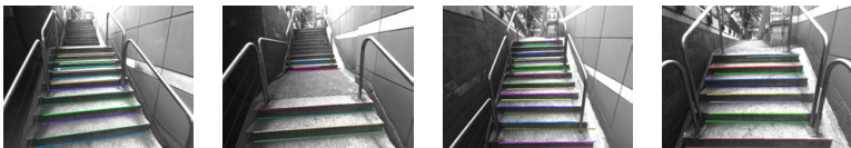
(e) Getrackte Liniensegmente, dieselbe Farbe kennzeichnet gleiche Liniensegmente.
