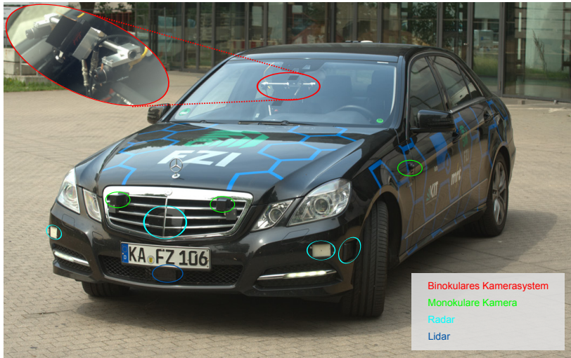
Bild 1.1: Sensorsetup des Forschungsfahrzeugs 'Bertha One' des Instituts für Mess- und Regelungstechnik (MRT) am Karlsruher Institut für Technologie (KIT)
