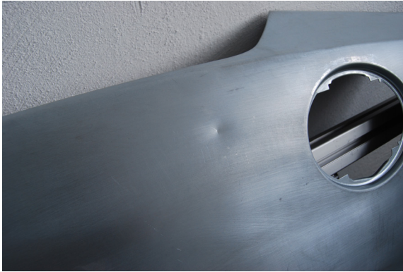
Abbildung 5.23: Untersuchtes Karosserierohblech. Mittig ist eine Delle zu erkennen, die in den Detailaufnahmen untersucht wurde.
