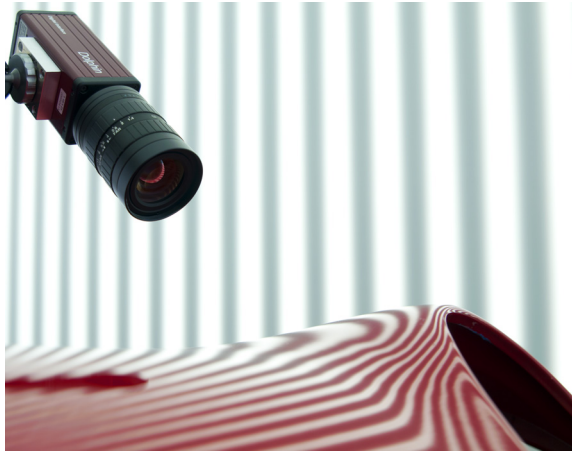
Abbildung 1.1: Beispiel einer deflektometrischen Messung. Die Kamera beobachtet die Reflexion des strukturierten Musters im Hintergrund auf der zu untersuchenden Oberfläche.
