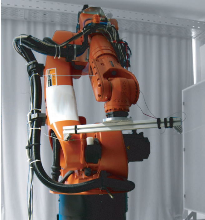
Abbildung 6.4: Der verwendete Industrieroboter: Ein KUKA KR 60 HA ermöglicht das Handling von Kamera und Mustererzeugern. Hier ist ein einfacher Draht zur Mustererzeugung zu sehen. Bei dieser Konfiguration stehen Kamera und Prüfobjekt unbewegt vor dem Roboter.
