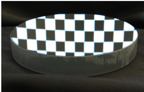
Abbildung 4.8: Foto des untersuchten Spiegels. Es handelt sich um einen metallbedampften Parabolspiegel mit 152 mm Durchmesser und einer Brennweite von 1524 mm.
