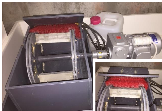
Abb. 3: Testverfahren für kombinierte chemische und mechanische Beanspruchung (Fotos Middendorf)
