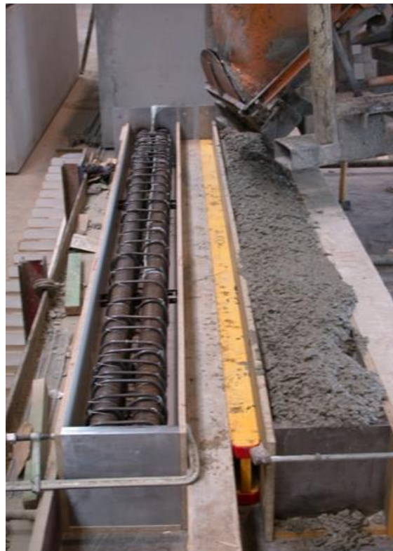
Abb. 23: Versuchsstütze mit hoch-festem Betonstahl für den Brandversuch [20]
