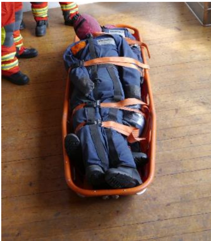
Abbildung 10: Zwei Feuerwehrübungspuppen mit 100 kg und 70 kg auf der Schleifkorbtrage der Berufsfeuerwehr Karlsruhe übereinander festgurtet.
