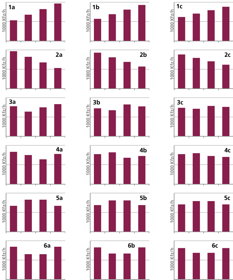
Abbildung 4-5 Kompaktdarstellung des Verkehrsstärkeverlaufs der Zuflussprofiltypen in 15-Minuten-Intervallen
