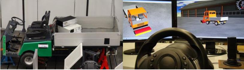
**Abbildung 5:** Range-Extender „in the Loop“ – links: Fahrzeug auf Prüfstand, rechts: Fahrzeug in virtueller Prüfsumgebung
