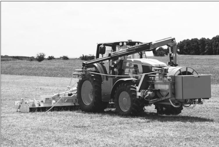
**Abbildung 3:** Testfahrzeug mit angebauten Leitungsführungskomponenten
