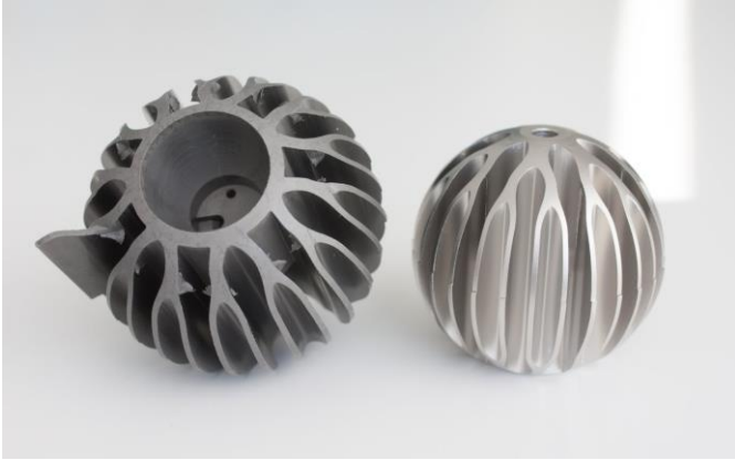
Abbildung 1.52: Musterteile aus Edelstahl - links: Grünteil aus Werkzeug mit ausgebrochenem Auswerfer an einem Teillast; rechts: Gesintertes Fertigteil
