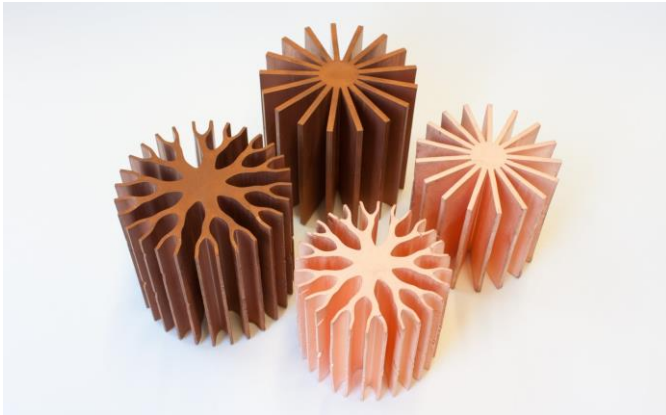
Abbildung 1.51: Zylinderförmige Kühlkörper als Grünteile sowie entbindert und gesinterte Fertigteile
