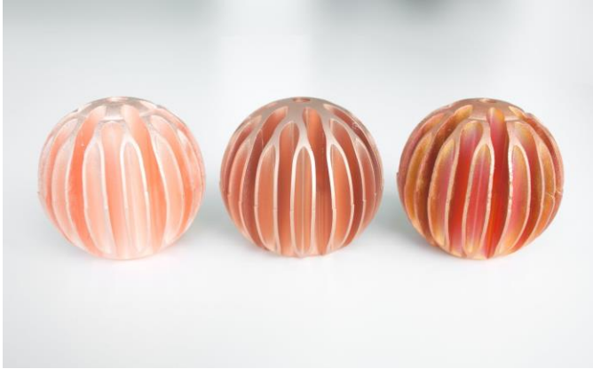
Abbildung 1.53: Oberflächenbehandlung der Sinterteile aus Kupfer von links nach rechts: unbehandelt, sandgestrahlt mit Korngröße 30 \mu\text{m} , CVD-beschichtet mit 300 nm bis 400 nm \text{SiO}_2 s
