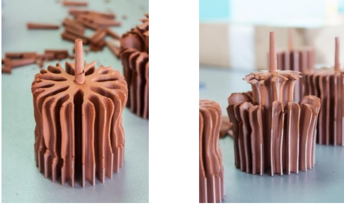
Abbildung 1.50: Fehlerhafte Grünteile – links: unvollständig gefülltes Teil; rechts: beim Entformen zerstörtes Teil
