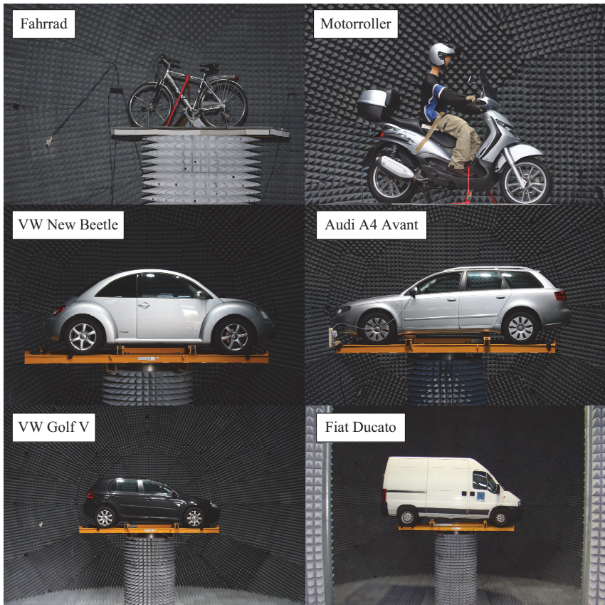
Abb. 3.13: Vermessene Fahrzeuge in der RCS-Messkammer des Institute for the Protection and Security of the Citizen des JRC in Ispra, Italien. ©JRC und IEEE [SFGT + 11].
