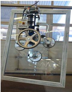
(a) Vakuum-Greifsystem für die Handhabung von Fensterelementen und Glasscheiben [2]
