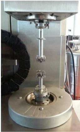
(a) ARES Versuchsapparatur für DMA-Messung
