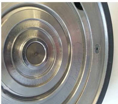
(b) Dichtlippen-Stabilisierung (verschraubt)
