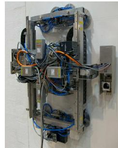
(c) Kletterroboter MANOLA zur thermischen Dekontamination von radioaktiv belasteten Oberflächen
