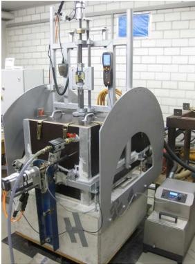
(a) Geschlossener Versuchsstand für Reibversuche
