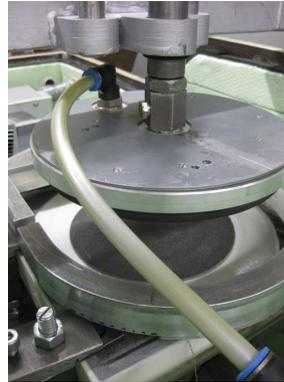
(b) Vakuumgreifer, Abspannelement und Probenschlitten
