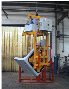
(b) Vakuum-Greifsystem für die Handhabung von Betonfertigteilen [83]
