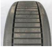
R3: Querrillen in einzelner Profilspur mit radialer Flanke, Referenz zu R4
