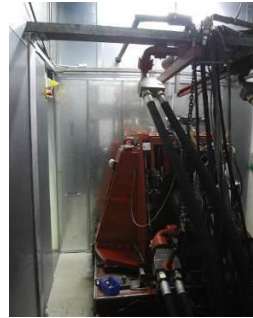
Abbildung 23: Gekapseltes Hydraulikaggregat in Antriebskammer
