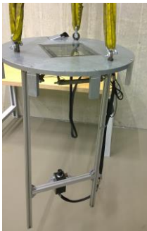
Abbildung 28: Unterflurlabor vor dem Einsetzen in einen genormten Abwasserschacht
