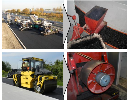
Abbildung 14: Vergleich des großtechnischen Fahrbahneinbaus (li. o. Fertiger mit Verdichtungsbohle [Hein14], li. u. schwere Walze BOMAG BW 174 [BOMA14]) und der Fahrbahnverdichtung mit den Gegebenheiten am Innentrommelprüfstand des FAST
