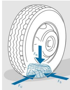
Abbildung 2: Kräfte und Druckverteilung am Reifen [Reif10]
