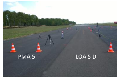
Abbildung 32: Versuchsstrecke 2 & 3: geräuschoptimierte Fahrbahnen PMA 5 (links) und LOA 5D (rechts), Länge 70 m, Breite je 3 m
