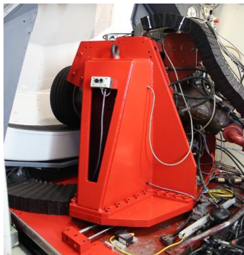
Abbildung 18: Innentrommelprüfstand mit Radaufhängung [FAST16].
