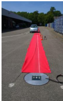
Abbildung 29: Anfahrt-Teppich mit eingesetztem Unterflurlabor
