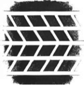
Abbildung 70: Realer Reifenabdruck, hergestellt über Abdruckverfahren am IPS auf Safety-Walk und 3.700 N Radlast
