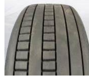
R4c: Querrillen in zwei Profilspuren, geneigte Flanke, gegenläufig ausgerichtet
