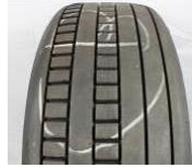
R4b: Querrillen in zwei Profilspuren, geneigte Flanke, identisch ausgerichtet
