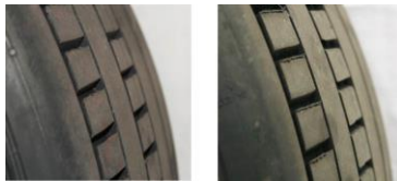
Abbildung 38: Reifen R4b mit identischer Blockneigung (beide Spuren MR2) und Reifen R4c mit gegenläufiger Blockneigung auf Spur 1 (MR2) und Spur 3 (MR1)
