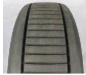
R4: Querrillen in einzelner Profilspur mit geneigter Flanke
