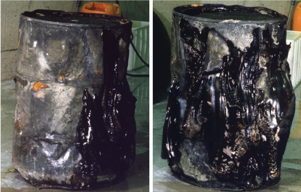
Abb. 13 Vorder- und Rückseite eines aus dem Atlantik geborgenen Bitumenabfallprodukts, das mindestens 10 Jahre in Kontakt mit Seewasser stand und Quellvorgänge zeigte.
