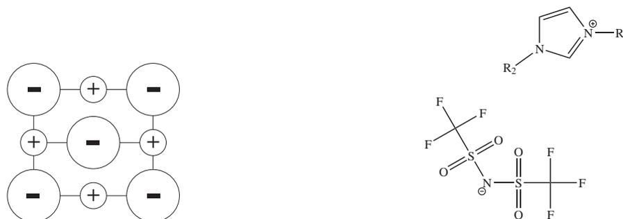
Abb. 2.2: Veranschaulichung des Unterschiedes zwischen einem NaCl-Typ (links) und einer ionischen Flüssigkeit  $[\text{C}_n\text{C}_m\text{IM}][\text{Tf}_2\text{N}]$  (rechts); verändert nach<sup>58</sup>.
