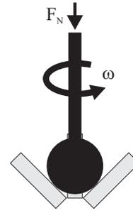
Abb. 3.3: Aufbau der tribologischen Messzelle im Rheometer.
