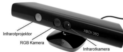
Abbildung 49: Microsoft Kinect Tiefenkamera [Golem 2016]
