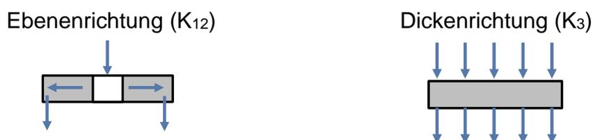
Abbildung 5.6: Fluidfluss zur Messung der Permeabilität
