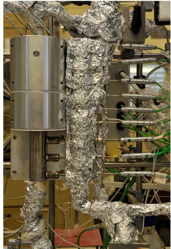
**Abbildung 8-29:** Reaktoreinheit bis Multiportventil zur Selektion der Zapfstellen (links) sowie vergrößerte Darstellung des Reaktors mit abgenommenem unteren Heizblock (rechts).
