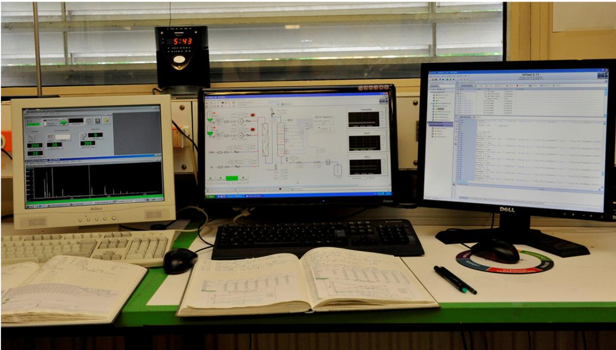
**Abbildung 8-30: Prozessleitsystem und Peripherie der kontinuierlich operierenden Anlage. Steuerungs- bzw. Auswertungssystem der GC-Analytik (links), Prozessleitsystem (Mitte) sowie Automatisierungssoftware (rechts).**
