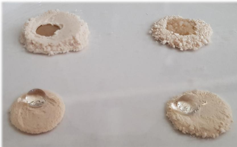
**Abbildung 4-7:** Foto verschiedener Zeolithe benetzt mit einem Tropfen Wasser. Links-oben: H-BEA 25, links-unten: H-BEA 25 silyliert, rechts-oben: H-MFI 90, rechts-unten: H-MFI 90 silyliert.
