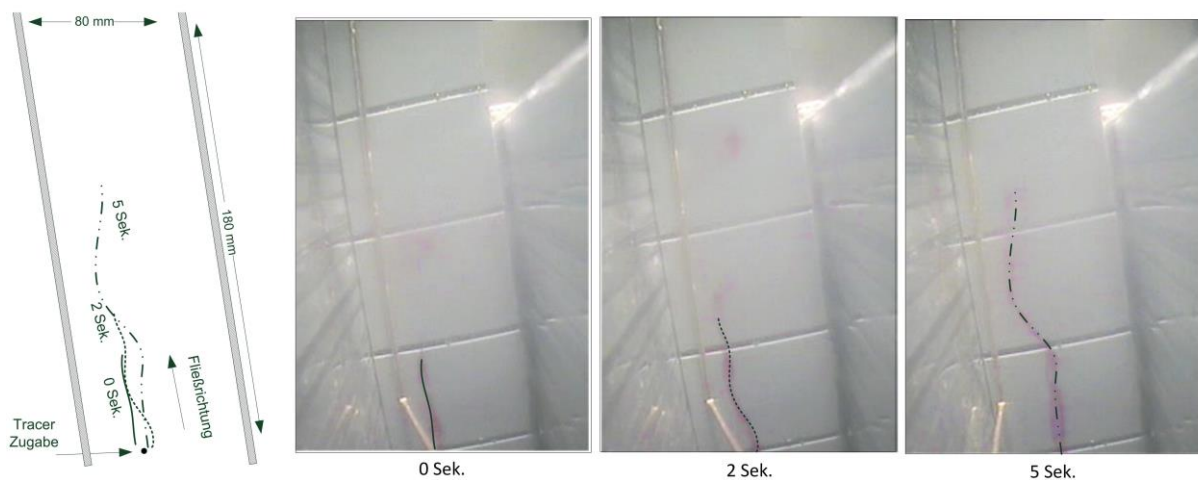
Abbildung 51: Verteilerrohr Pos. 3.1 ( q_A = 4 \text{ m/h} )
