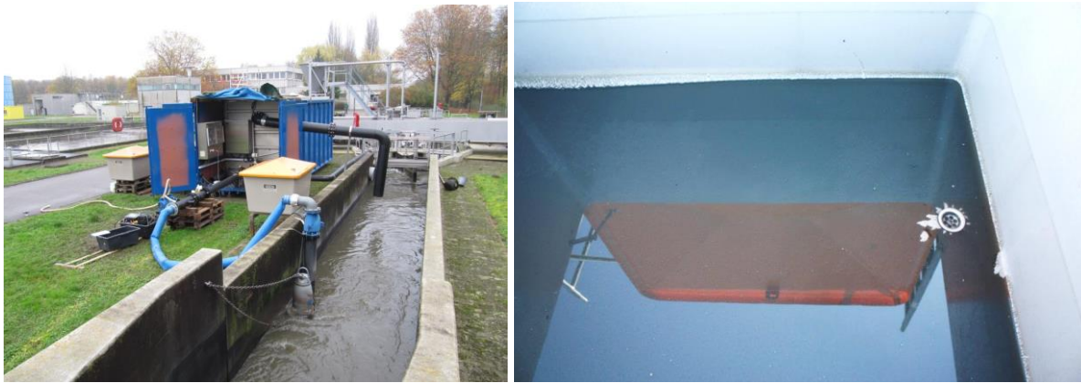
Bild 7: Versuchsstand (links) und Feststoffsammler mit Sedimentablagerungen (rechts)
