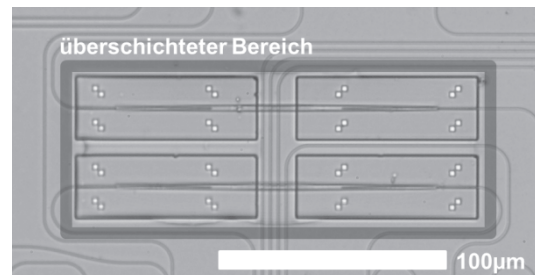
Abb. 87: Lokal überschichtete Photonische Wirebonds
