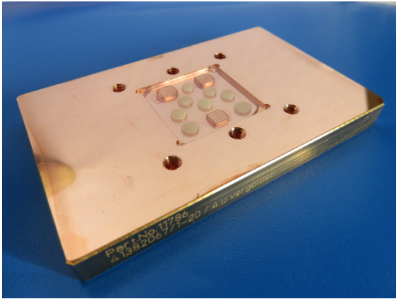
Abb. 84: Kupfergrundplatte mit kapillargeklebtem Glasmaster (25x25 mm 2 ) zur Formeinsatzherstellung durch Galvanoformung
