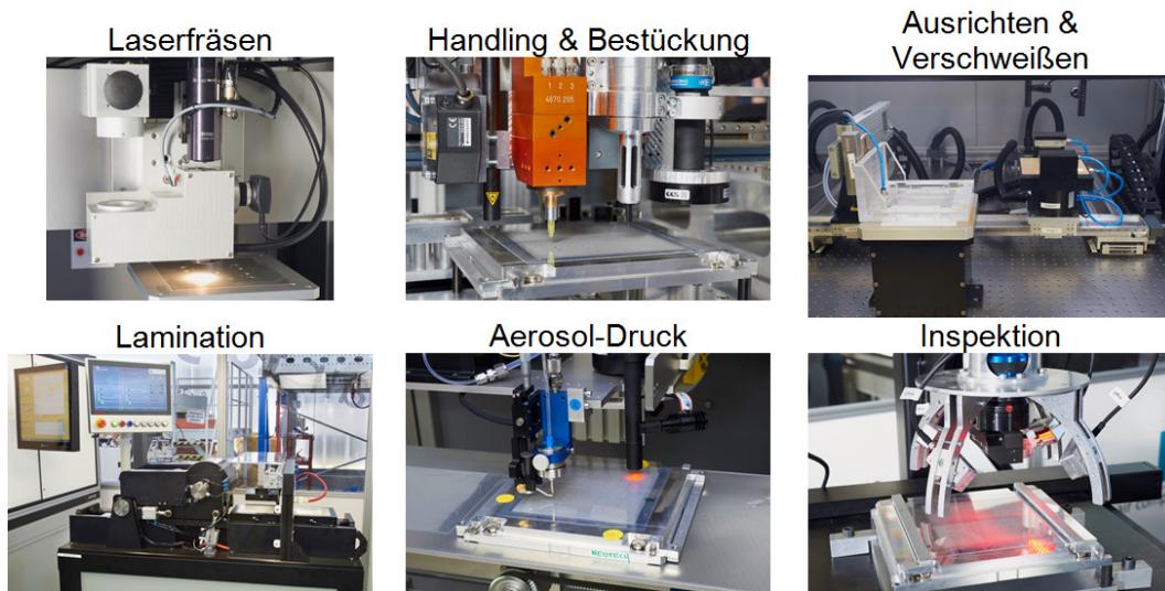
Abb. 76: Einzelmodule in der SMARTLAM Prozesskette (Fotos: KIT)
