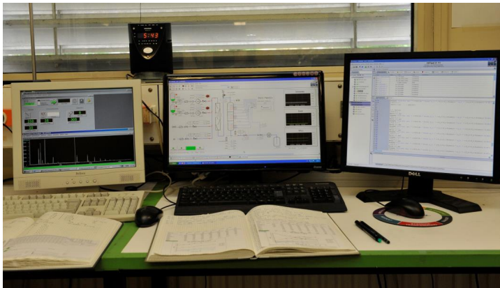
Abbildung A-30: Prozessleitsystem und Peripherie der kontinuierlich operierenden Anlage. Steuerungs- bzw. Auswertungssystem der GC-Analytik (links), Prozessleitsystem (Mitte) sowie Automatisierungssoftware (rechts).
