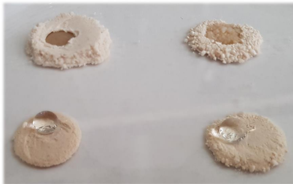
Abbildung 4-7: Foto verschiedener Zeolithe benetzt mit einem Tropfen Wasser. Links-oben: H-BEA 25, links-unten: H-BEA 25 silyliert, rechts-oben: H-MFI 90, rechts-unten: H-MFI 90 silyliert.
