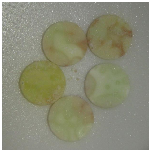
Abbildung 3.3: Foto von 5 LLZO-Pellets (Mie) nach dem letzten Sinterschritt. Die gelblich-grüne/bräunliche Verfärbung deutet auf minimale Verunreinigungen durch Fremdionen hin, da reines LLZO weiß sein sollte.
