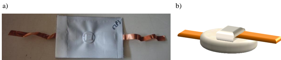
Abbildung 3.5: Foto einer Li/LLZO/Li-Pouch-Zelle (a), sowie eine schematische Zeichnung des inneren Aufbaus (von Jörg Illig) (b).
