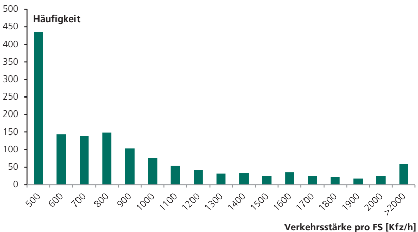
Abbildung 5-2 Häufigkeit der Verkehrsstärke pro Fahrstreifen innerhalb der Spitzenstunde (Daten der Berliner Dauerzählstellen)
