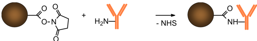
Abbildung 3-2 Schematischer Ablauf der Proteinbindung an die Partikeloberfläche
