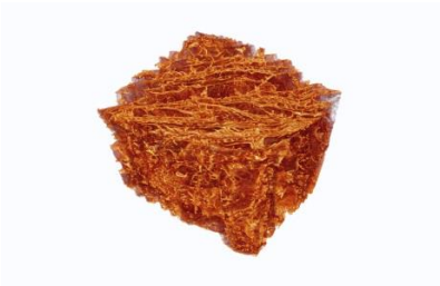
Abb. 3-20: Röntgen-Mikro-CT-Aufnahmen der Porenstruktur. Mit Hilfe der 3D-Röntgenbildgebung konnte die Interkonnektivität der Porenstruktur analysiert werden. Die Proben wurden vor der Messung getrocknet und zerstörungsfrei untersucht. Aufgrund des Formverlustes der Cryogelproben bei einer Gefrieretemperatur von -80^{\circ}\text{C} , wurde ausschließlich eine Messung der Proben bei 1h/5h_{-21^{\circ}\text{C}} durchgeführt. (Maßstabsbalken 500 µm)
