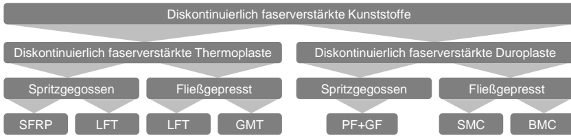
Abbildung 2.7: Klassifikation der diskontinuierlich faserverstärkten Kunststoffe
