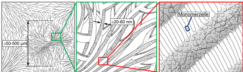
Abbildung 2.5: Darstellung der Polymerkettenanordnung in Sphärolithen
