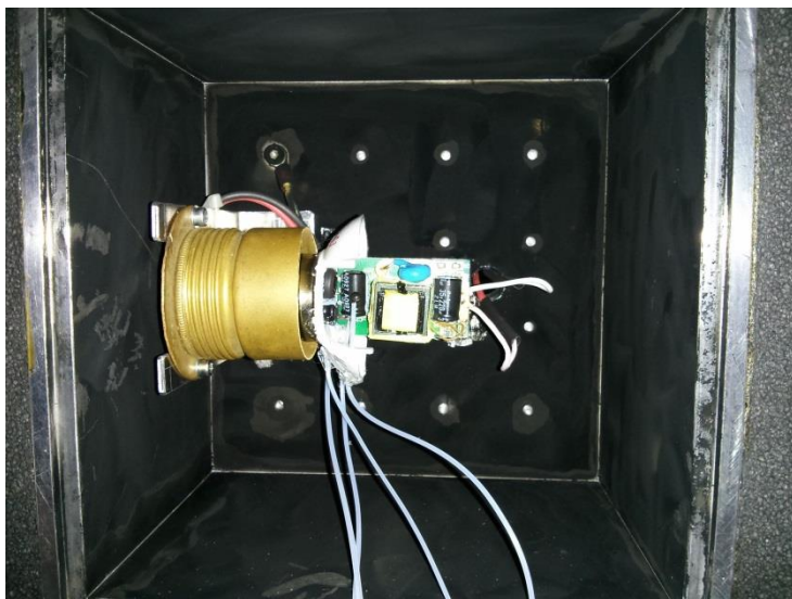
Abbildung 5.5: EVG in rußbeschichteter Thermobox
