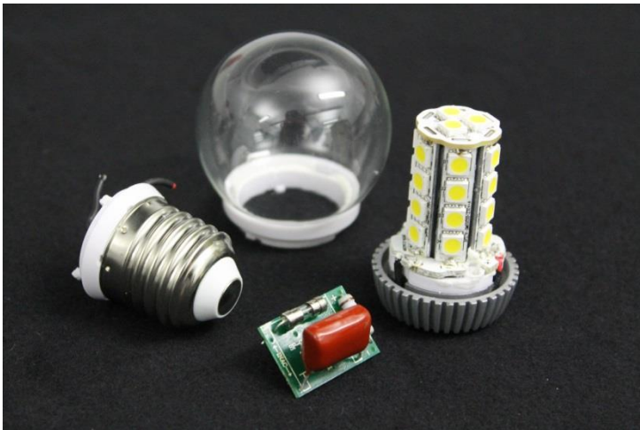
Abbildung 5.11: LED-Retrofit mit Kondensatornetzteil
