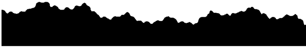
Abbildung 2.10: Exemplarisch gemessene Oberfläche mit Gestaltabweichung der 1. bis 4. Ordnung (überhöht) (DIN 4760:1982).
