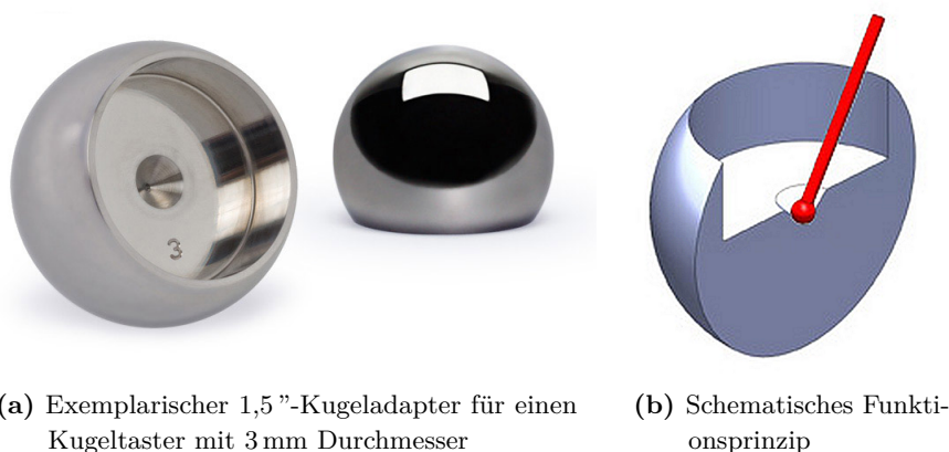
Abbildung 3.21: Kugeladapter mit Aufnahme für einen Kugeltaster sowie Darstellung des Funktionsprinzips ([BI16c]).
