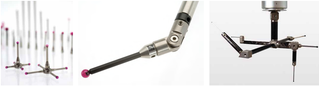
Abbildung 3.9: Exemplarische Kugeltasterkonfigurationen (sternförmig, mit Gelenk und komplex) ([Ren09]).
