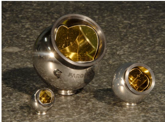
(a) SMR mit den Kugeldurchmessern 0,5 ", 7/8 " und 1,5 "
