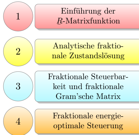
Abbildung 7.1: Zentrale Schritte zum Entwurf einer fraktionalen Optimalsteuerung
