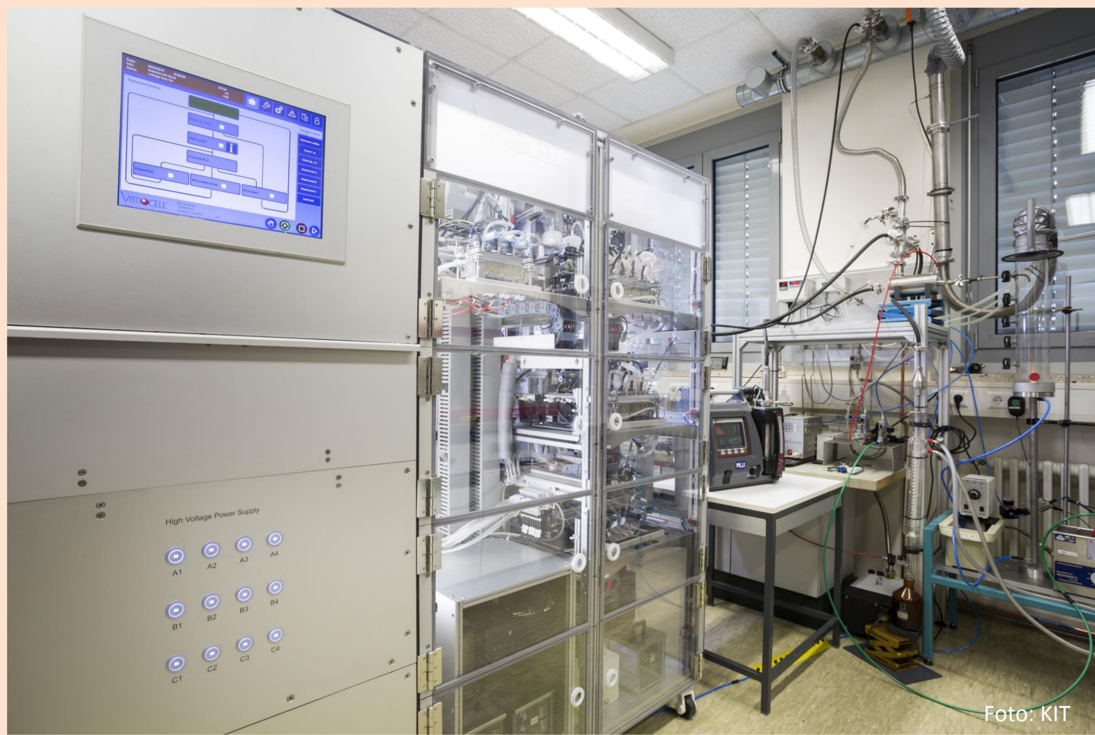
Fotografie des Gesamtaufbaus zur Untersuchung der Verbrennungsabgase
