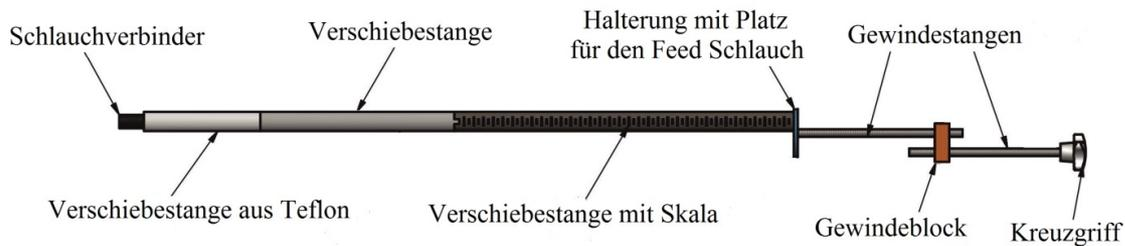
Abbildung 10-1 Vorrichtung zur reproduzierbaren Verschiebung des Membranmoduls während der Filtration im 200 MHz Tomographen
