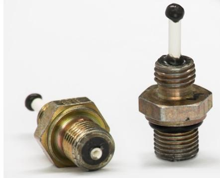
Abbildung 3-2 Probenhalterung für Porometermessungen
