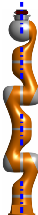
Abbildung 5.21: Der Roboter befindet sich in der Position „Kerze“, bei der alle Gelenkwinkel den Wert 0^\circ haben.
