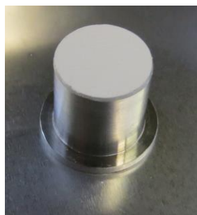
Abbildung 3-1: Edelstahlprobenehmer mit Probe eines \text{CaCO}_3 -Filterkuchens (Ansicht von unten)
