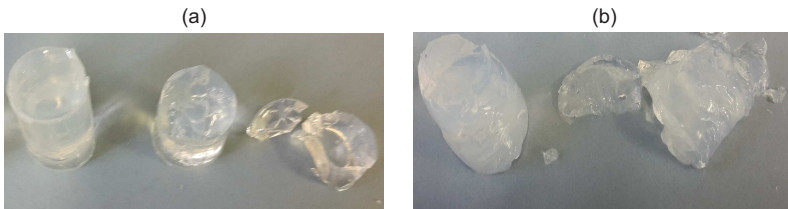
Abbildung 4.1: Hergestellte, zylindrische Gelproben, sauer- (a) und basisch-katalysiert (b)
